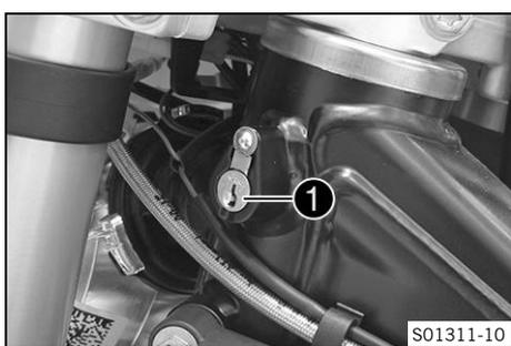
Il bloccasterzo **1** si trova a sinistra sul canotto di sterzo. Il bloccasterzo permette di bloccare il manubrio della motocicletta. In questo modo non sarà possibile sterzare e, quindi, guidare.
