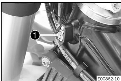
Il bloccasterzo **1** si trova a sinistra sul cannotto di sterzo. Il bloccasterzo permette di bloccare il manubrio della motocicletta. In questo modo non sarà possibile sterzare e, quindi, guidare.
