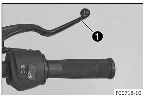
La leva del freno anteriore ❶ è situata sul manubrio a destra. Il freno della ruota anteriore viene azionato con la leva del freno anteriore.
